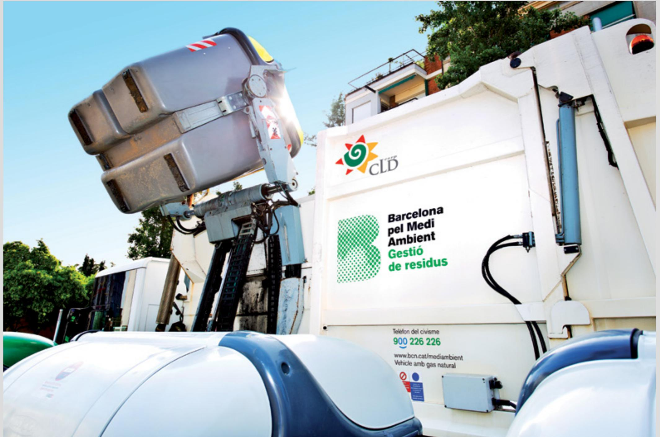
Vehículo de recogida selectiva de residuos mediante carga posterior y carga superior.
