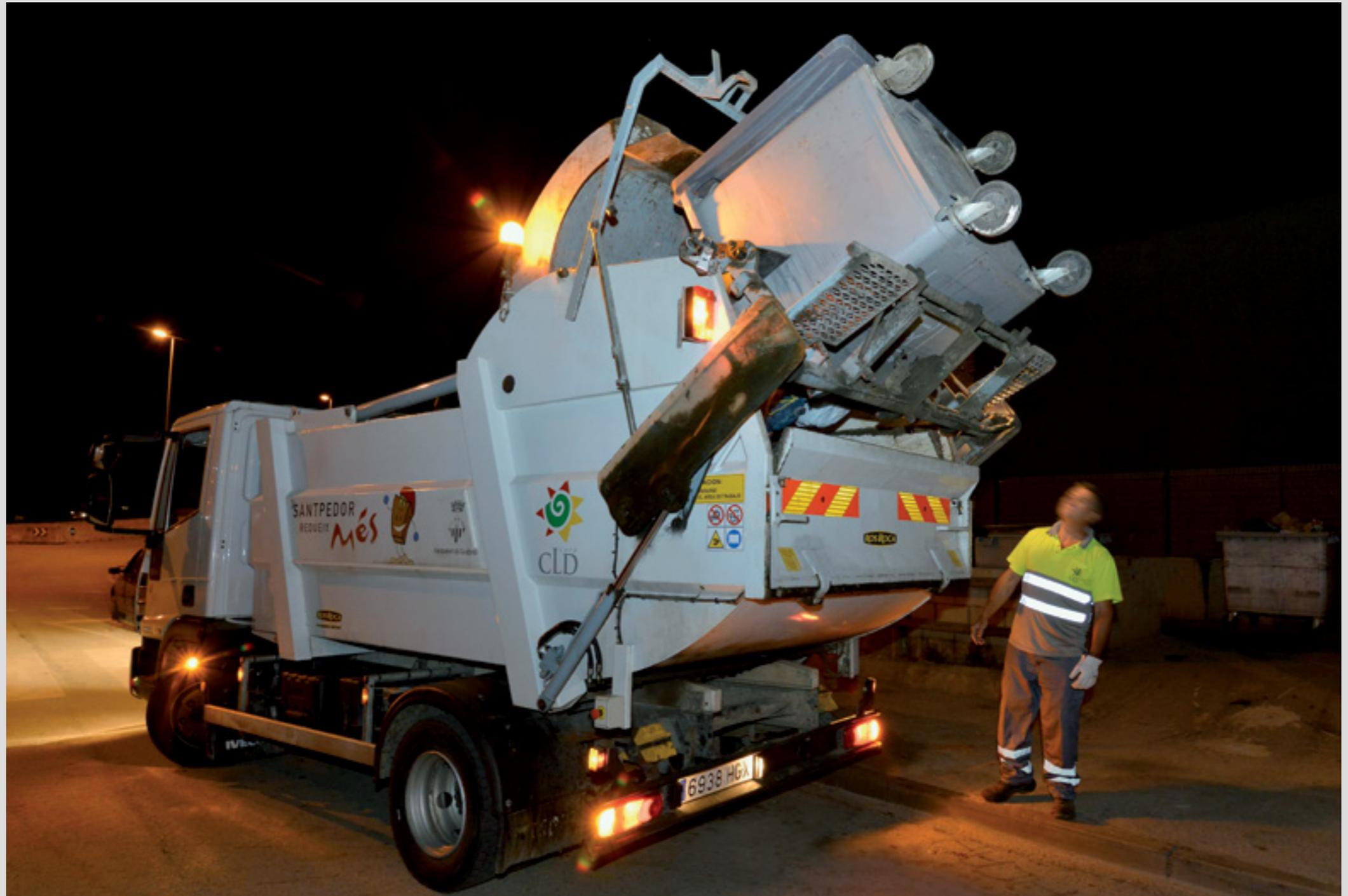
Vehículo de carga posterior bicompartimentado de recogida selectiva simultánea de dos fracciones de residuos.
